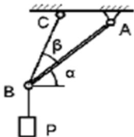
2. Груз весом  $P = 10$  Н подвешен на двух тросах АВ и ВС, составляющих с горизонтальной прямой углы  $\beta = 15^\circ$  и  $\alpha = 30^\circ$ . Определить усилия в тросах.
